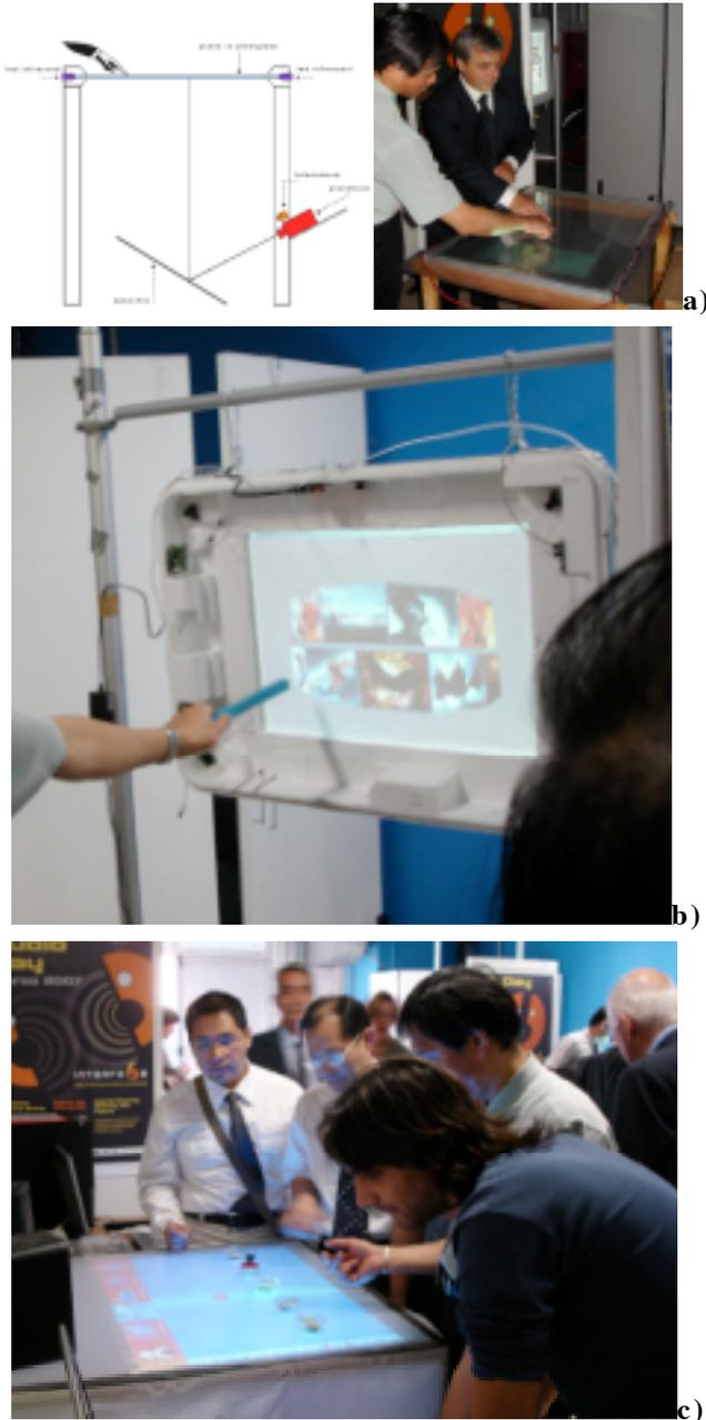
**Fig. 4: Prototipi utilizzando l' ISIM\_GestureCapture: un tavolino multitouch (a), una bacheca che consente di interagire tramite "bacchetta magica" (b) e un sintetizzatore che utilizza dei marker attivi a led infrarossi (c).**
